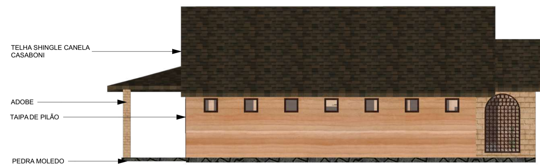
FACHADA LATERAL - CENTRO ADM.
