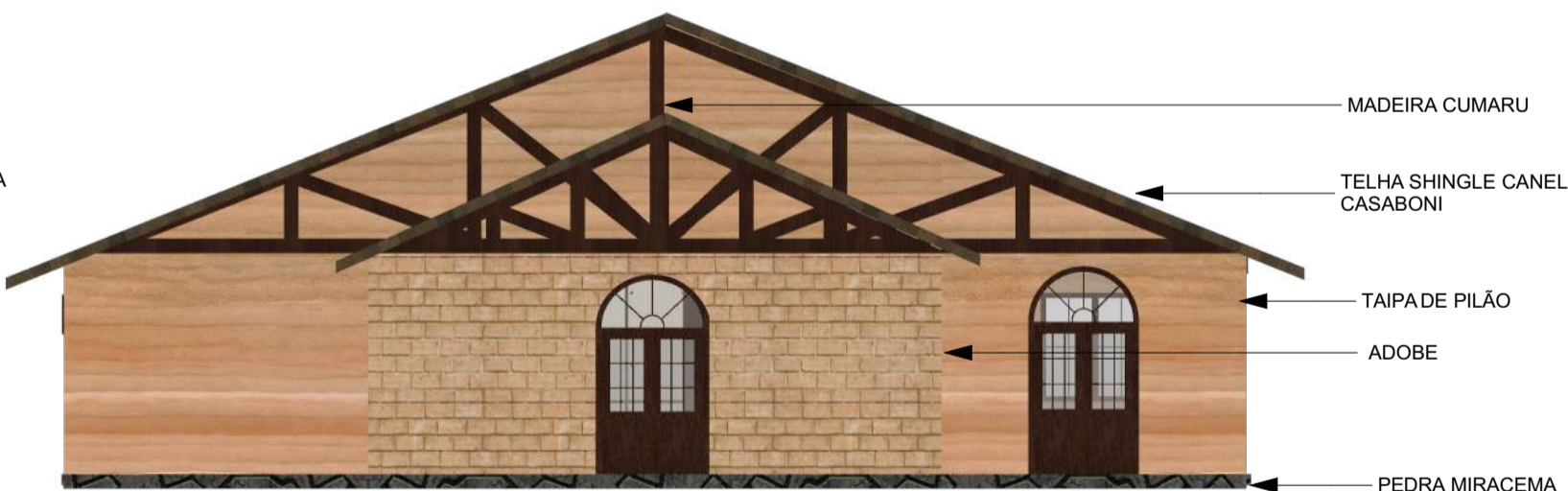
FACHADA FRONTAL - CENTRO ADM.
