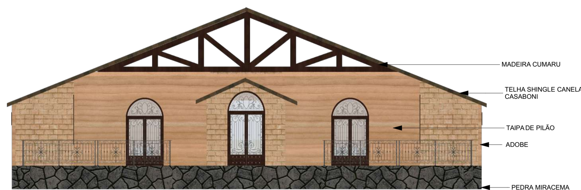
FACHADA FRONTAL - CAFETERIA
