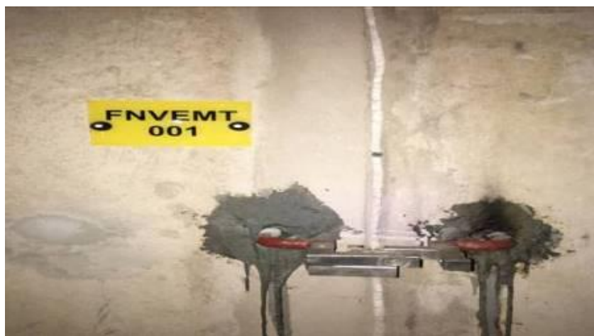
Figura 32 - Medidor Triortogonal de Junta
