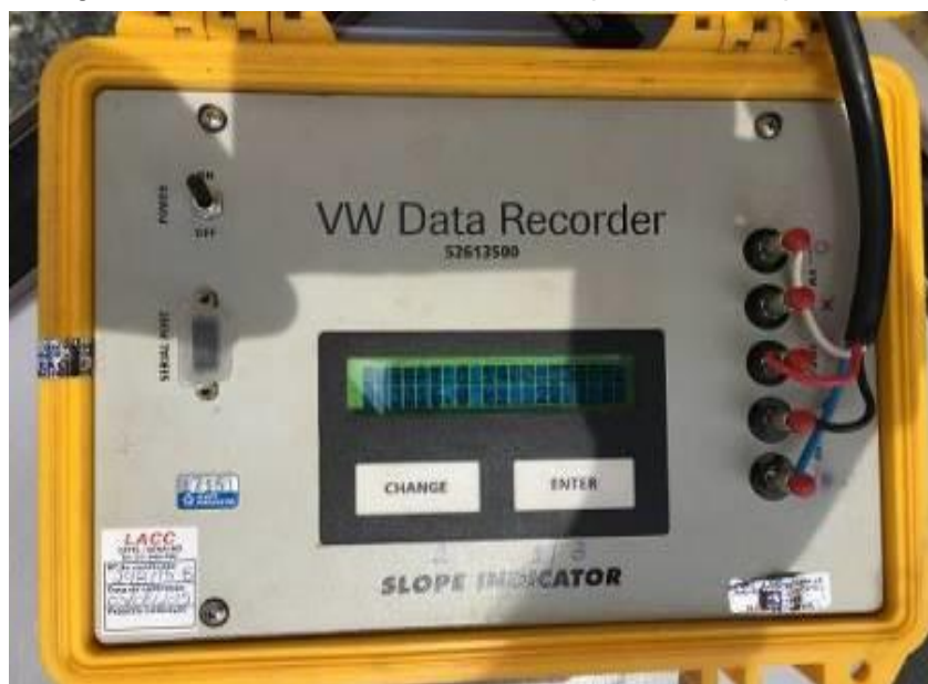
Figura 25 - Leitura dos valores de frequência e temperatura
