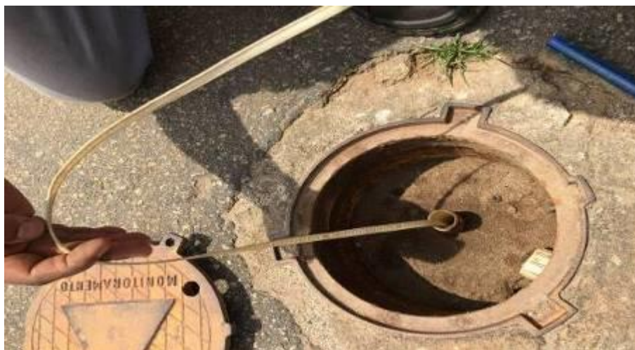
Figura 17 - Medição Piezômetro casagrande
