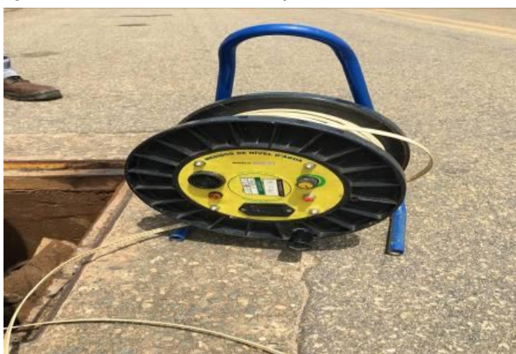
Figura 18- Instrumento de medição – fita métrica eletrônica
