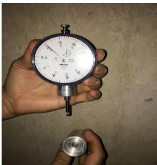
Figura 33 - Aferição padrão do instrumento Invar
