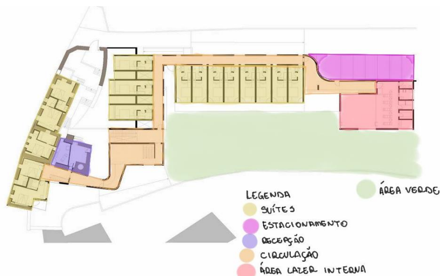
Figura 6 – Setorização Planta Primeiro Pavimento.
