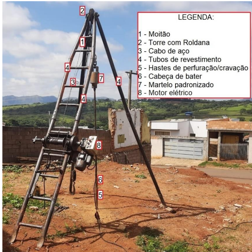
Figura 44 - Detalhamento do equipamento de SPT.
