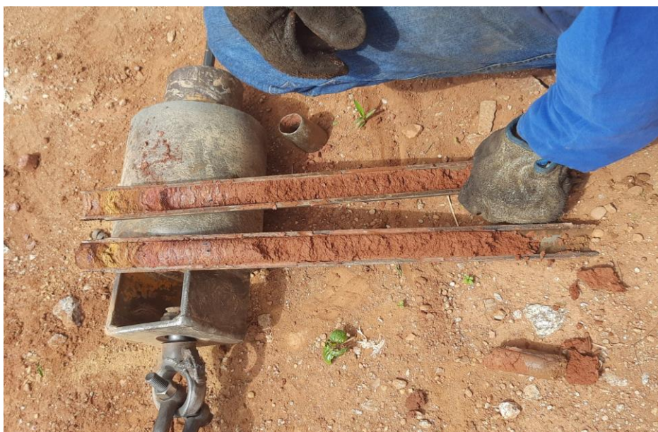
Figura 46 - Haste de perfuração com amostra do solo.
