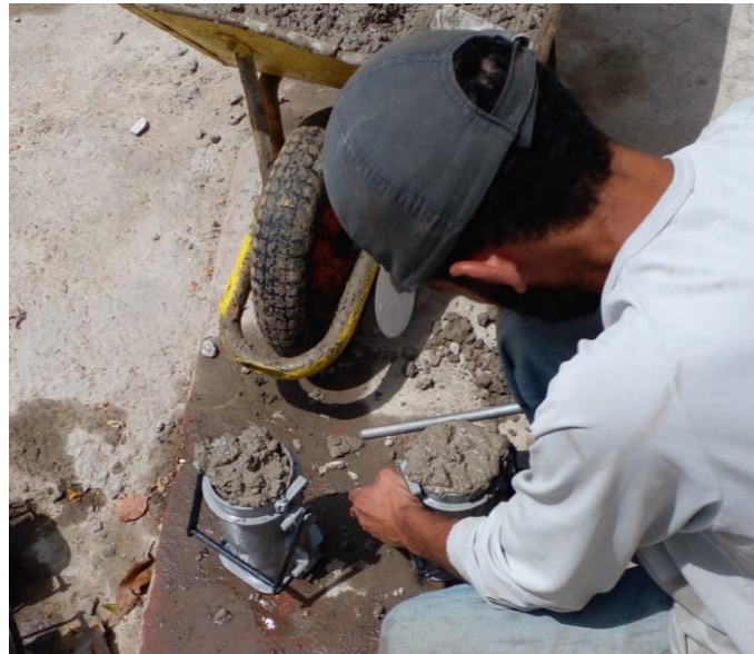
Figura 25 - Formas de corpos de prova após a concretagem
