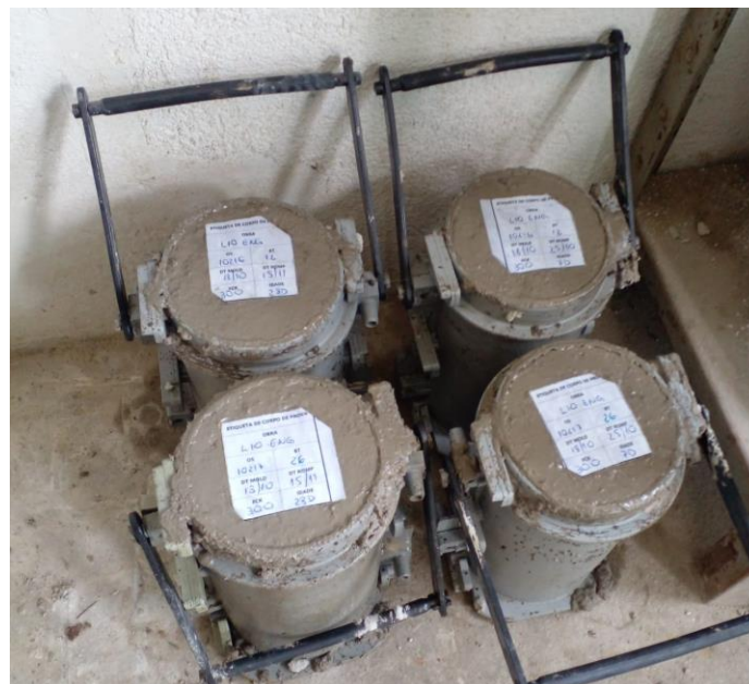
Figura 25 - Formas de corpos de prova após a concretagem
