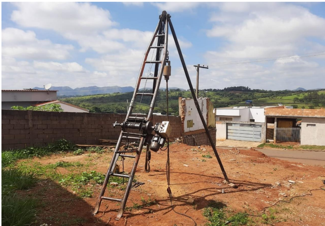
Figura 43 - Equipamento utilizado para análise de solo SPT.
