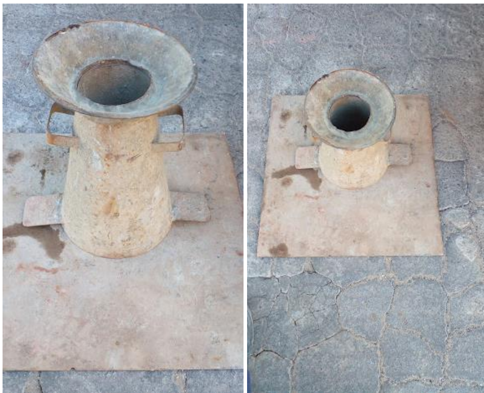
Figura 14 - Teste do Cone de Abrams
