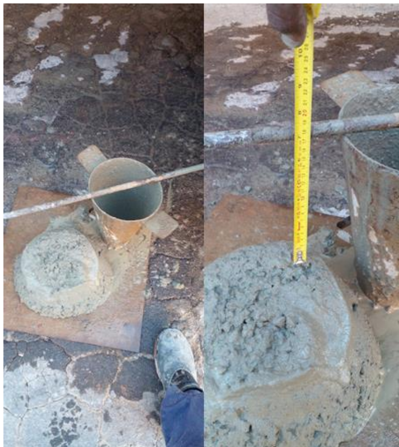
Figura 15 - Abatimento do concreto
