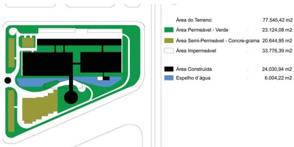
Figura 33: Relação de área verde e área construída.
