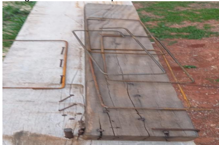
Figura 131 - Gabarito para dobra de estribos
