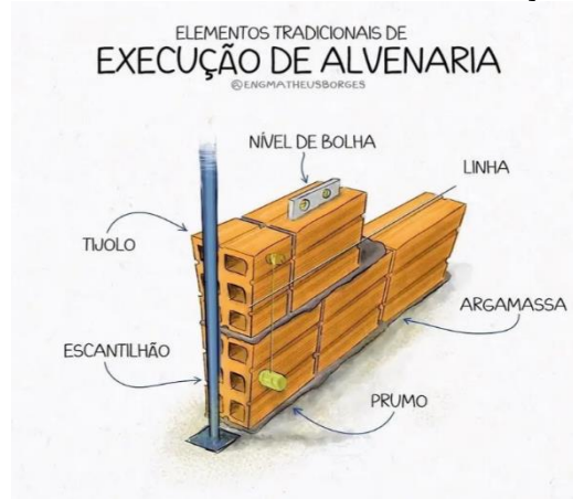
Figura 145 - Elementos tradicionais de execução de alvenaria
