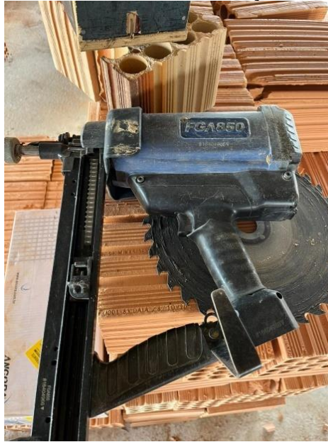
Figura 102 - Ferramenta de fixação dos pregos
