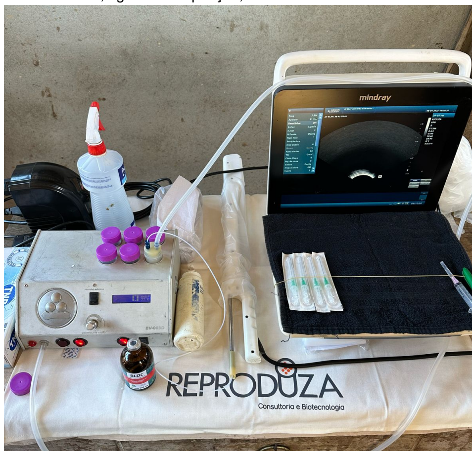
Figura 6 – Mesa de aspiração contendo: ultrassom Mindray DP-50, guia de aspiração e transdutor microconvexo, agulha de aspiração, bomba de vácuo e fármacos anestésicos.
