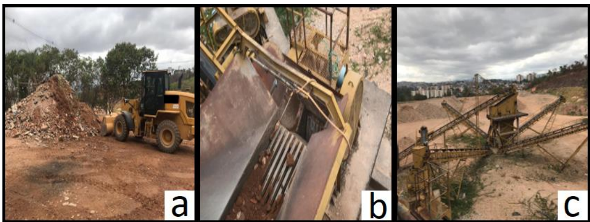
Figura 1: Separação bruta, britagem, refino e separação granulométrica
