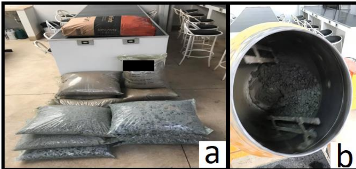
Figura 6: Estoque dos materiais e homogeneização do concreto na betoneira
