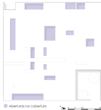
Figura 45 – Aberturas na cobertura.
