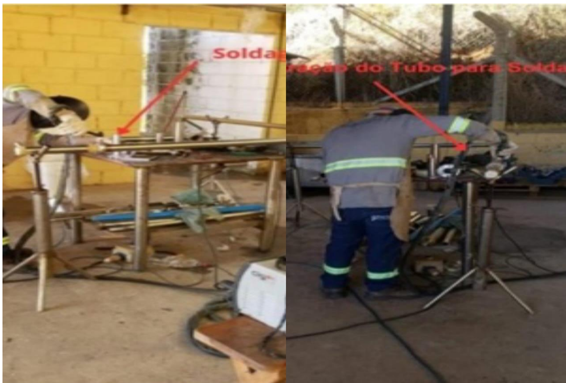
Figura 3 - Soldagem TIG aço inoxidável.
