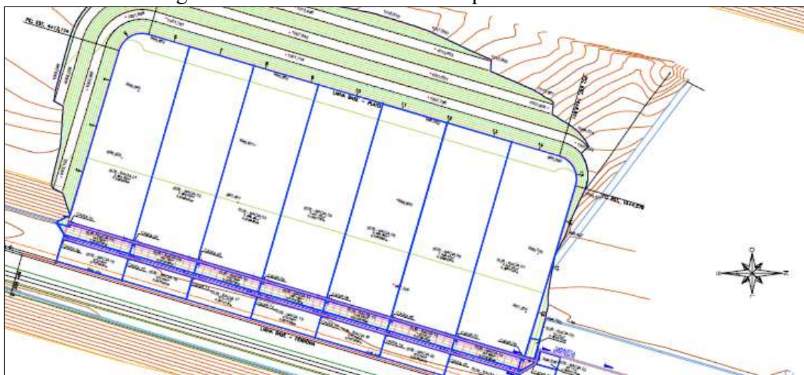
Figura 79 – Subdivisão da área do platô em sub-bacias
