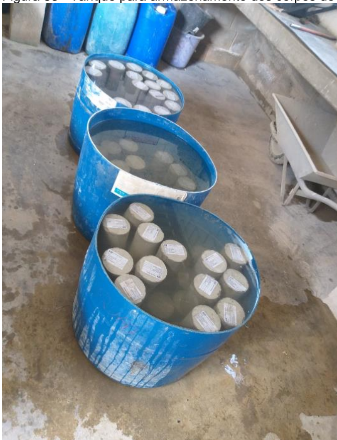
Figura 83 - Tanque para armazenamento dos corpos de obra
