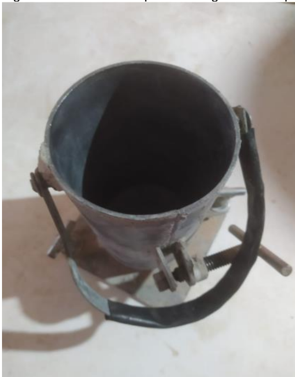
Figura 80 - Forma seca para moldagem dos corpos de prova
