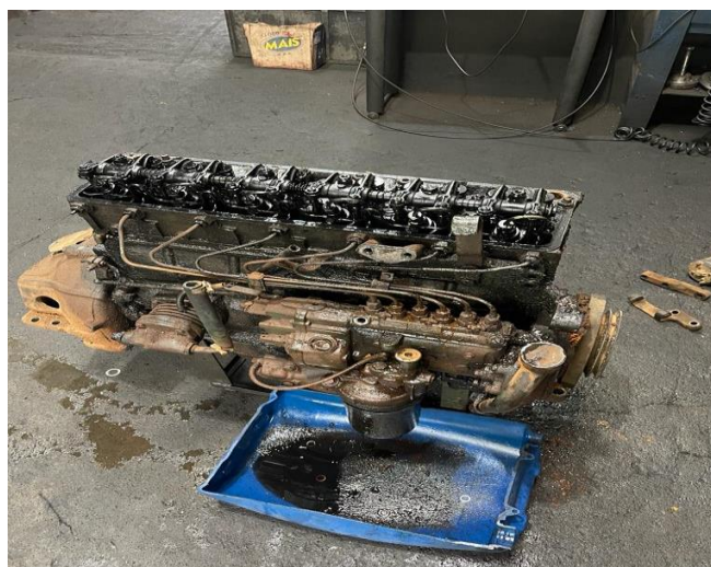
Figura 1: Desmontagem do motor 352A Mercedes Benz.
